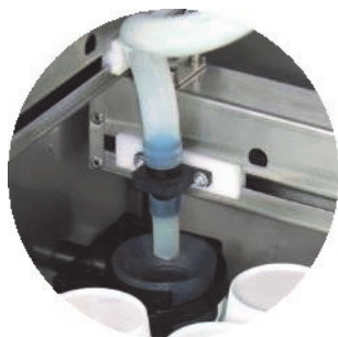
Pozycja spustowa w tylnym lewym rogu; opcjonalnie w tylnym prawym
