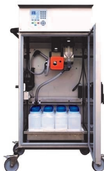
Próbopobierak podwójny z dwoma niezależnymi systemami poboru
